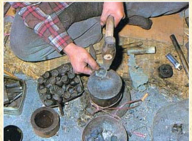
담뱃대는 대나무 양쪽에 대통과 물부리를 끼워넣어 완성한다. 대통은 'L'자 모양으로 휘어져 담배를 넣어 불을 붙이는 곳이고, 물부리는 입으로 연기를 들이마시는 곳으로 모두 쇠를 녹여 단련해 만든다.
