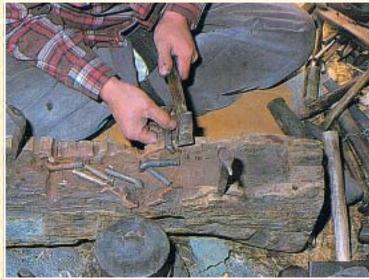
담뱃대는 대나무 양쪽에 대통과 물부리를 끼워넣어 완성한다. 대통은 'L'자 모양으로 휘어져 담배를 넣어 불을 붙이는 곳이고, 물부리는 입으로 연기를 들이마시는 곳으로 모두 쇠를 녹여 단련해 만든다.
